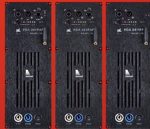
PDA281PAF 带 Dante™、TCP/IP、及 aptX™ 蓝牙扩展方案面板图
